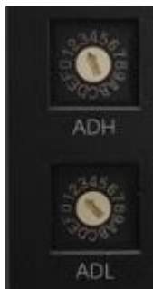
图 2-5 产品正面 DP 地址开关图
