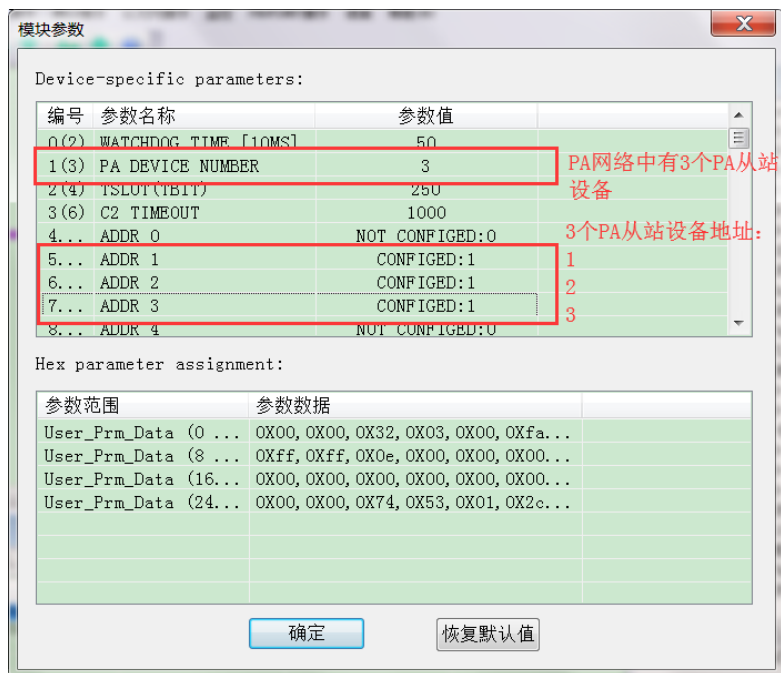
图 4-7 DP-PA 耦合器的 PA 总线基础配置
