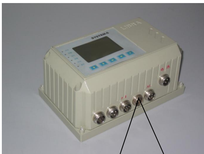
图 3-10-1 带有高 IP 等级 PROFIBUS 插座的电子称
