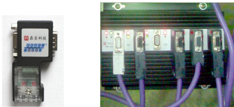
图 3-8 连接 PROFIBUS 设备的标准 PROFIBUS 插头
