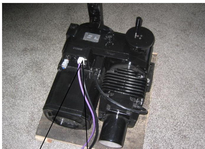
图 3-10-2 带有高 IP 等级 PROFIBUS 插座的阀门定位器
