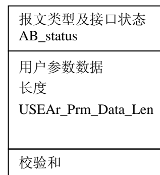
图 4-15 接口板回答输出数据报 文格式 B
